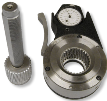
Kombo-Verzahnungslehrringe mit Messuhr (analog oder digital) zum Prüfen der effektiven und tatsächlichen Zahndicke an Werkstücken mit Außenverzahnung. Combo spline ring gauges with dial gauge (analogue or digital) for checking effective and actual tooth thickness on external splined work pieces.
