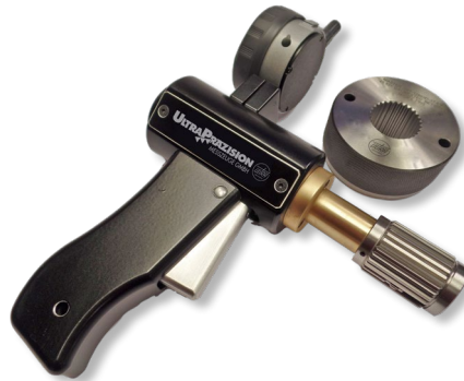
Kombo-Verzahnungslehrrorne mit Messuhr (analog oder digital) zum Prüfen der effektiven und tatsächlichen Zahnlückenbreite an Werkstücken mit Innenverzahnung. Combo spline plug gauges with dial gauge (analogue or digital) for checking effective and actual circular space width on internal splined work pieces.
